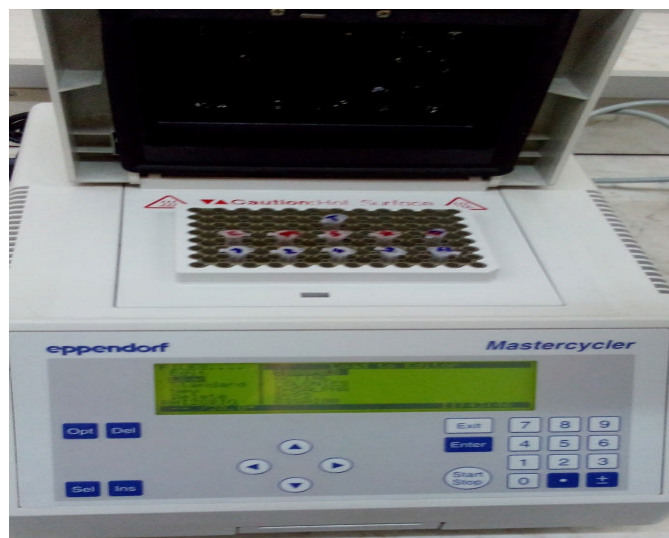
Figure 13- Thermocycleur utilisé dans la réaction de PCR
